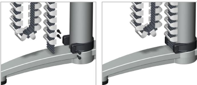
und unten am Standrohr montieren und lose ausrichten. Kabelkette spannen und Schrauben fest ziehen.
