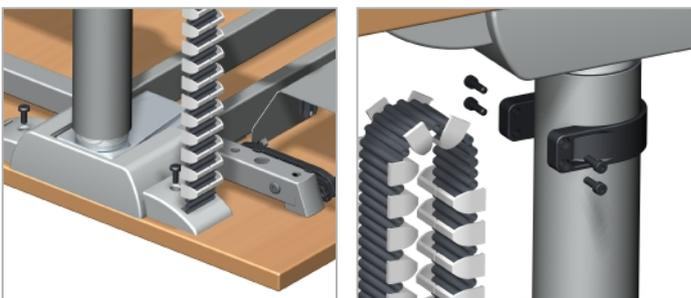
Kunststoffblende mit Kabelkette montieren. Kabelkette und Klammer mit je 4 Schrauben oben
