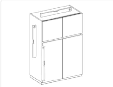
Grundschränke nach Wasserwaage ausrichten.
