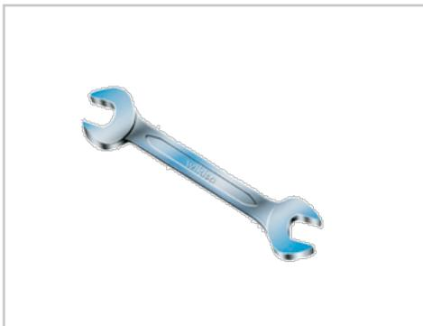
Unterbau Gestell: Bodenunebenheiten ausgleichen durch Verstellen der Stellschrauben (max. 15 mm). Werkzeug: Maulschlüssel SW 19.
