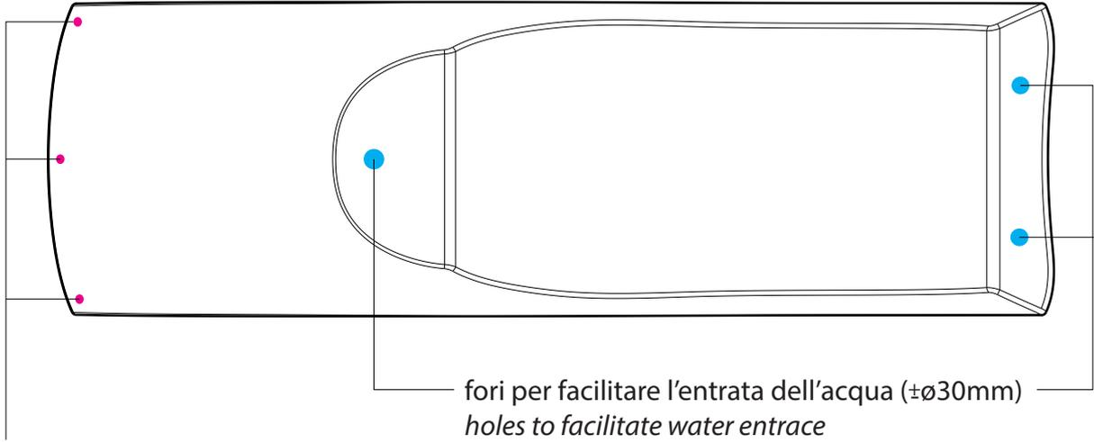
fori per facilitare l'uscita dell'aria (±ø8 mm)
