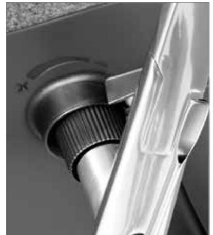
Die vorne drehbar gelagerte Schale sitzt im hinteren Bereich über zwei Druckfedern auf dem v-förmigen Träger auf. Durch die Kapselung der Federn sehen sie wie Stoßdämpfer aus. Eine bildet den Kraftspeicher, mit der anderen lässt sich die Vorspannung einstellen. Der Hebel zur Auslösung der Höheneinstellung ist dezent und schlank integriert.
