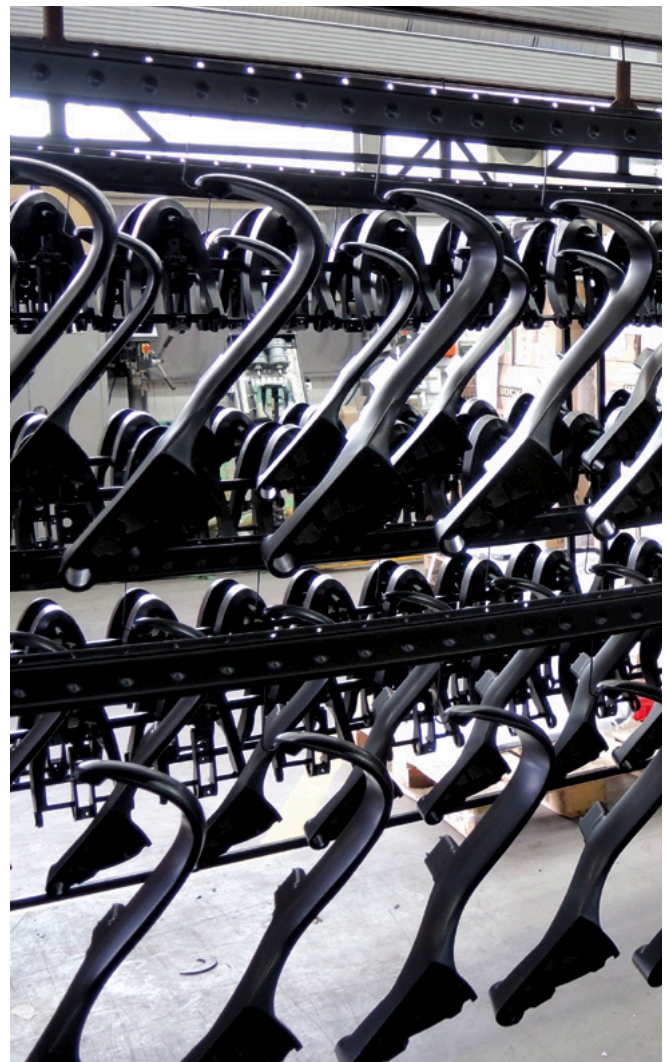
Vor dem Pulverlackieren wird jedes Teil auf einwandfreie Oberflächenbeschaffenheit und weitere Qualitätsmerkmale kontrolliert.
