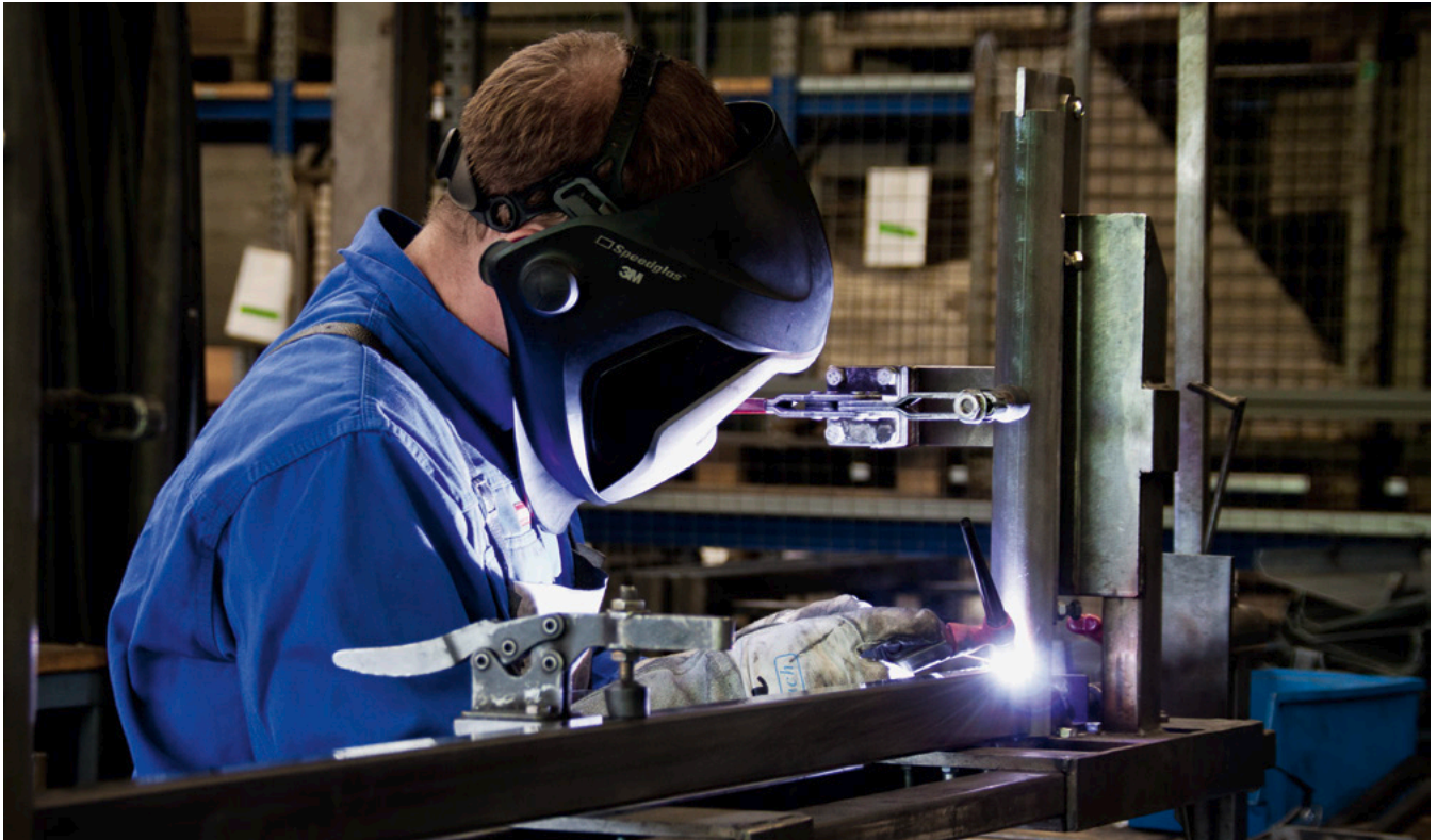
Im Stahlbau entstehen aus Rohren und Blechen präzise und langlebige Gestelle für Wilkhahn-Tische. Die Spezialausrüstung sorgt für Sicherheit beim Schweißen, die Wartung und die Kontrolle der Maschinen schützt die Umwelt.
