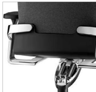
Trimension® mit Doppelmechanik: Die geöffnete Mechanikabdeckung gibt den Blick auf die beiden Federn frei, die für die Abstimmung des Gegendrucks in alle Richtungen sorgen.
