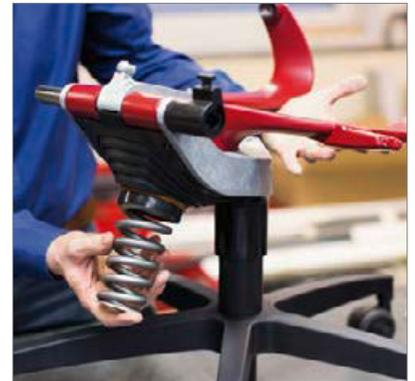
Trimension® mit Direktgetriebe und Zentralfeder: Die beiden Schwenkarme sind Teil der Mechanik und sorgen je nach Bewegungsrichtung für das Zusammendrücken oder seitliche Verkippen der Feder.
