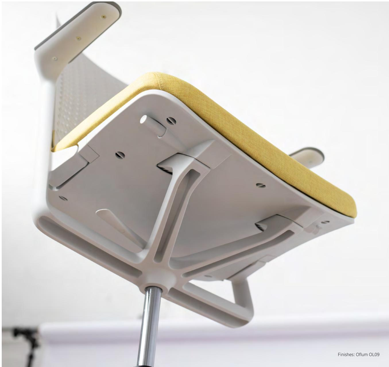
**Die Standardlösung mit Metallfedern wurde hier durch eine patentierte Konstruktionslösung ersetzt, bei der im unteren Teil ein Querelement eingesetzt wurde, das als Torsionsfeder wirkt und einen sehr komfortablen Bewegungsbereich gewährleistet. Die Funktionsweise des Stuhls und die Widerstandskraft der Rückenlehne reagieren auf das Körpergewicht des jeweiligen Nutzers und passen sich diesem automatisch an.**
